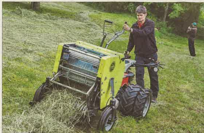
Am Hang wurde vorgeführt, wie Heu zu handlichen Rundballen gepresst wird. (Bild: Otto Graf)
